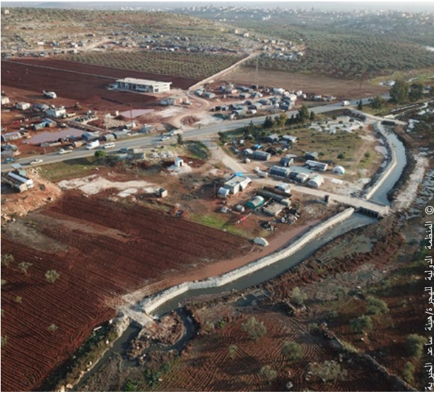
شكلت قنوات تصريف مياه العواصف تدخلاً رئيسياً لتحسين المواقع بغية التخفيف من خطر الفيضانات.
