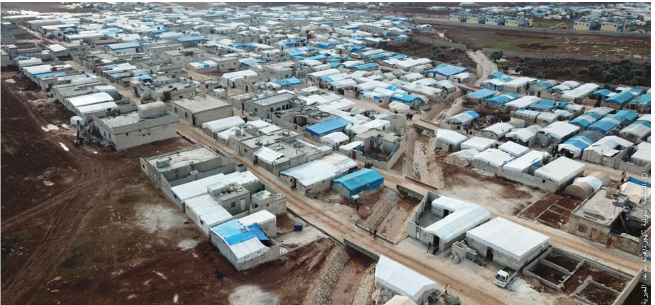
فُقدت تدخلات متنوعة استناداً إلى الاحتياجات والتقييمات التقنية لكل مخيم. وشملت بناء شبكات مفتوحة ومغلقة لتصريف المياه وشبكات الصرف الصحي والمجاري والطرق ورفع الخيام بـ ٢٠ سنتيمتراً عن الأرض بواسطة التحصيب.
